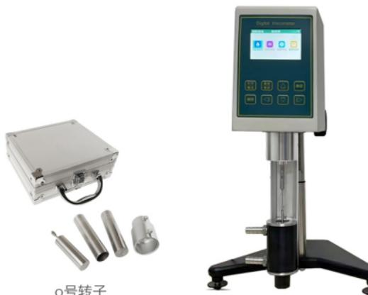
\* 注：0号转子为选配件,可测低粘度0.1mPa.s。专用于测量低粘度的样品,样品量仅需25ml;
